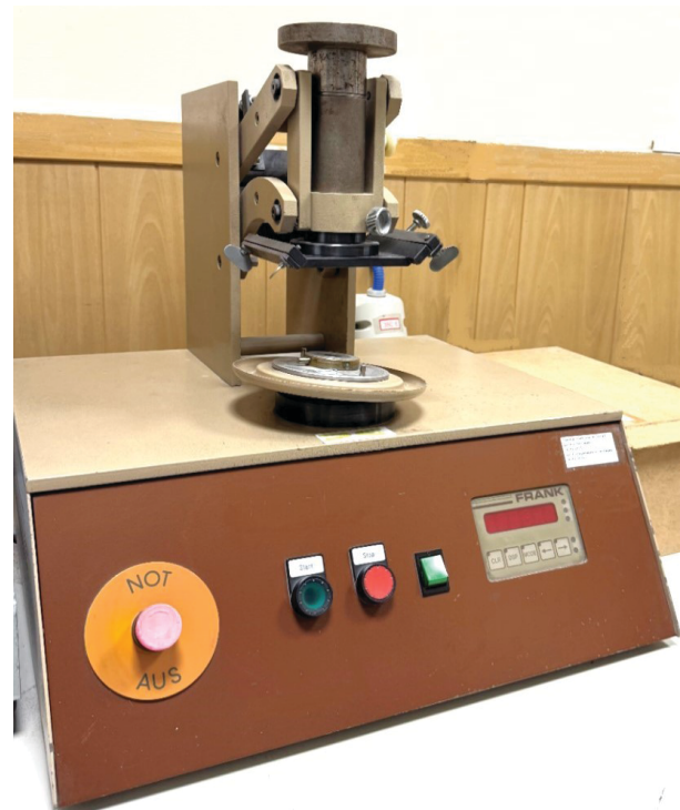
Рис. 2. Проведение испытания образцов линолеума с использованием прибора FRANK (модель 11401) Fig. 2. Linoleum samples testing using the FRANK device (model 11401)
