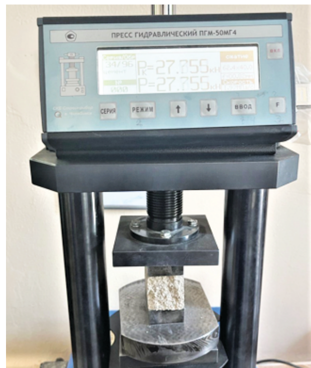
Рис. 3. Испытание образцов-балочек на прессе Fig. 3. Testing of beam samples on a press
